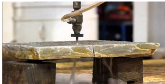
Hình 7. Cắt bê tông, đá hoa cương
