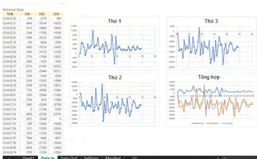
Hình 4. Kết quả gia tốc rung trong phần mềm Excel đối với ba cảm biến theo trục Oy và kết quả kết hợp
