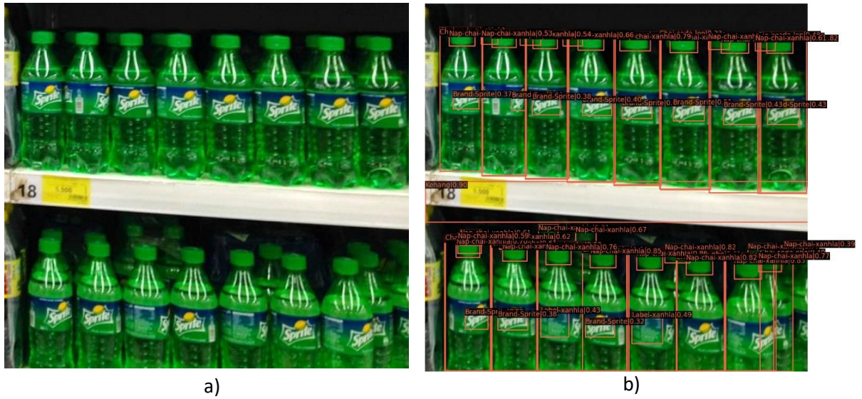
Hình 13: a) Ảnh đầu vào; b) Kết quả UniverseNet
