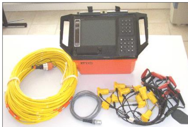
Hình 5. Máy thăm dò địa chấn Terraloc Mark-6, geophone và cáp nối
