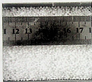
Hình 2. Hạt xốp EPS đường kính 1-2mm
