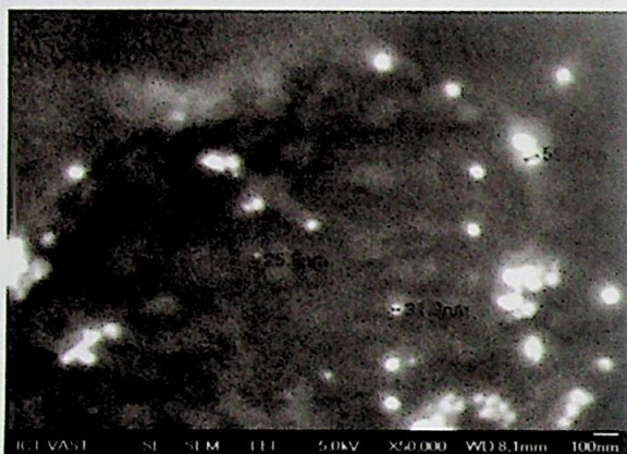
Hình 4. Ảnh SEM mẫu keo nano Ag
